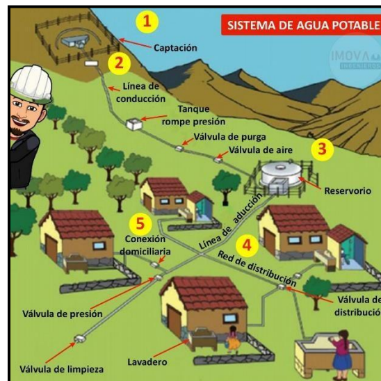
Figura 04: Sistema de abastecimiento de agua potable.
