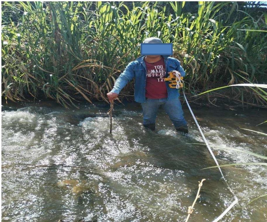
**Figura 9. Medición del ancho del río 3.60m**
