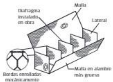
Fig. 9.19 Diseño esquemático del gavión CajaFuerte ®
