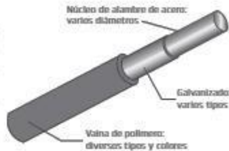
Fig. 9.10 Composición del alambre usado en productos de doble torsión
