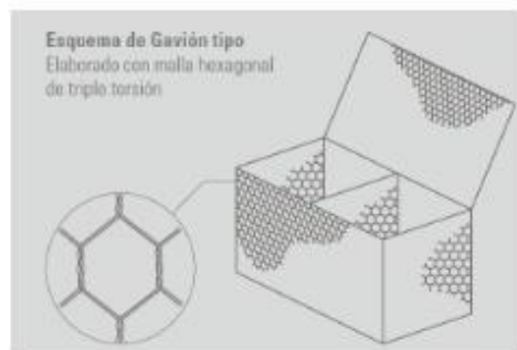
Figura 3. Esquema de Gavión tipo caja. Fuente:(A Bianchini, 2017).
