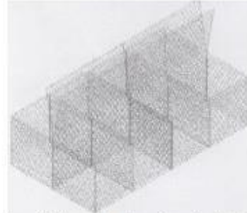
Figura 13. Amarrado entre gaviones. Fuente: (ACEROS METALES Y MALLAS LTDA, 2016)
