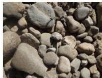
Figura 11. Rocas para el llenado de gabiones. Fuente: https://pixabay.com/es/photos/piedras-ripio-gabiones-de-piedra-1323243/
