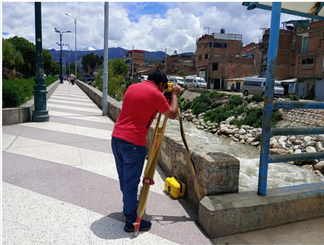
figura 43: Estoy tomando los puntos con el nivel y la mira para ver desplazamiento del volumen del enrocado Fuente: Elaboración propia.
