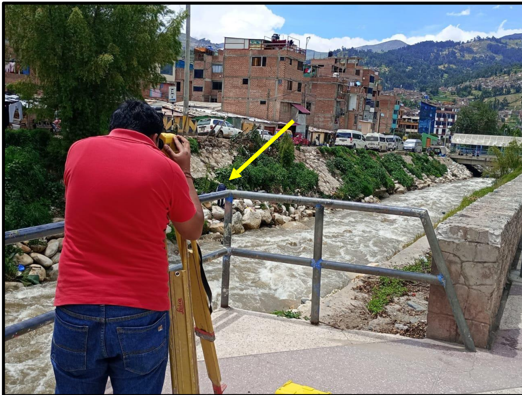
figura 47: Realizando la lectura de la mira, el ayudante bajo cerca de las aguas del río para ver del desplazamiento del enrocado Fuente: Elaboración propia
