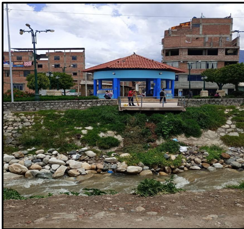
figura 45: lectura del nivel hacia otro punto con la mira Fuente: Elaboración propia.
