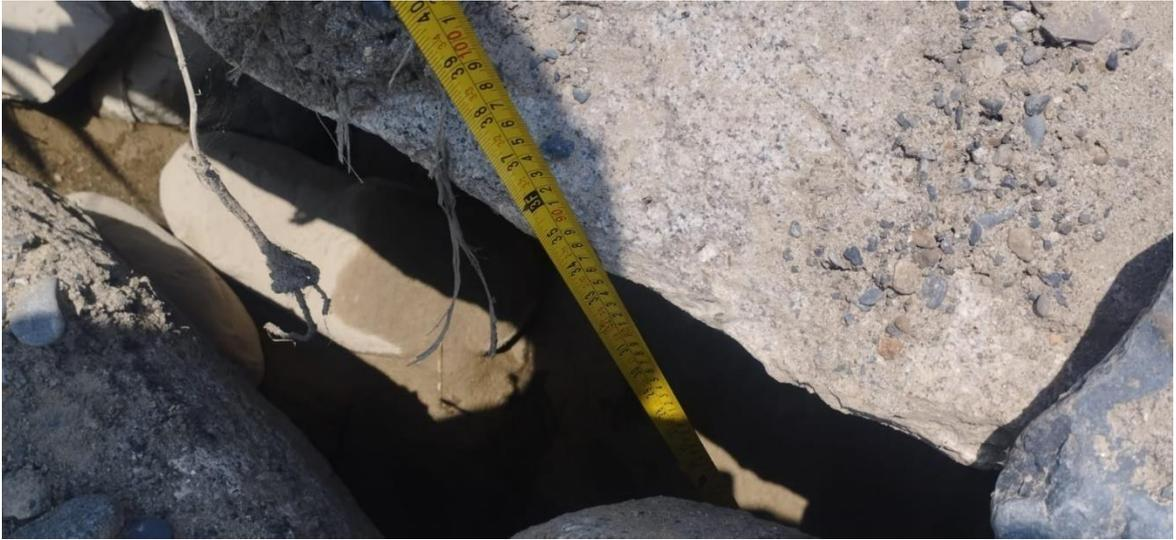
**Figura N° 3:** Medición de vacíos en medio de rocas grandes
