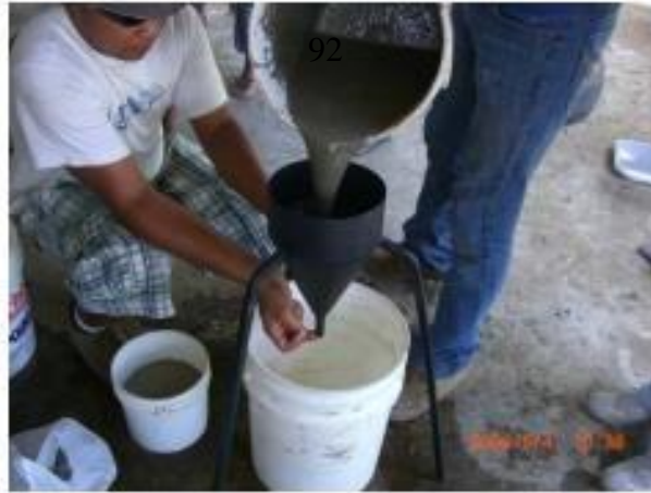
Foto 7-2. Prueba de fluidez de mortero de cemento
