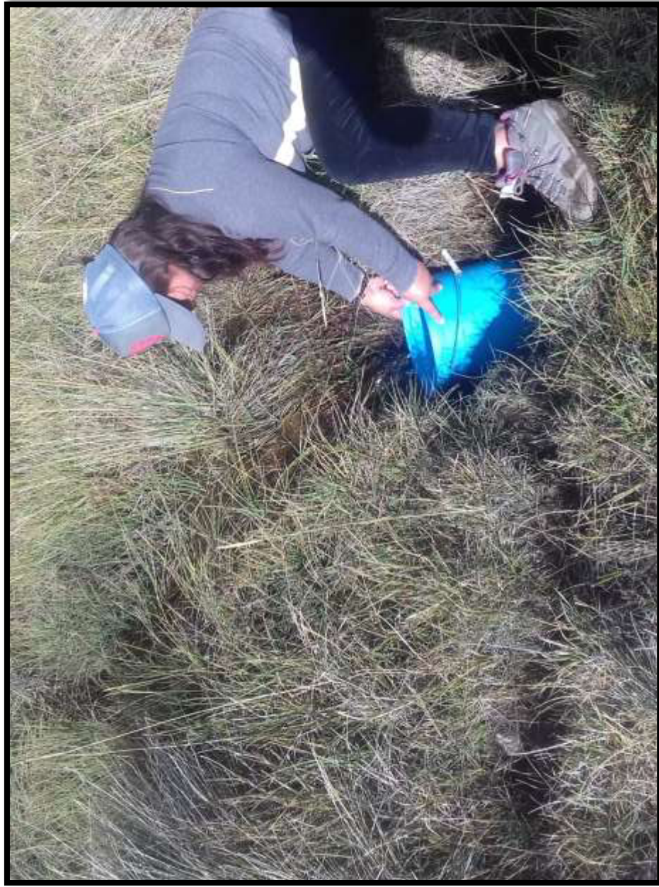
Figura 20. Vista del aforo de la fuente en un balde (8l) para el método volumétrico. Fuente: elaboración propia (2018)
