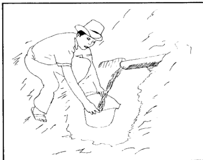
Figura 4. Aforo de agua por método volumétrico. Fuente: Roger Agüero Pittman (1997)
