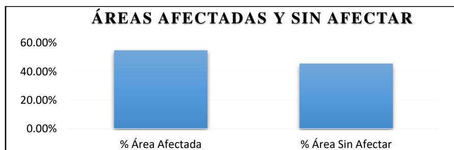
Gráfico 9 Estadísticas del área afectada y no afectada en sobrecimientos del Tramo N° 02
