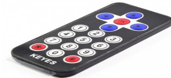
Figura 14. Control remoto infrarrojo
