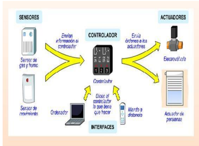
Figura 40. Estructura del sistema domótico
