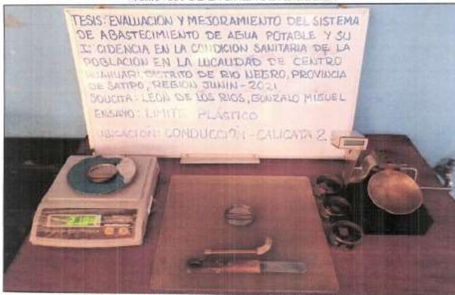
ENSAYO DE LIMITE PLASTICO DE LA CALICATA 3 UBICADO EN EL KM:0+885 DE LA LINEA DE ADUCCION
