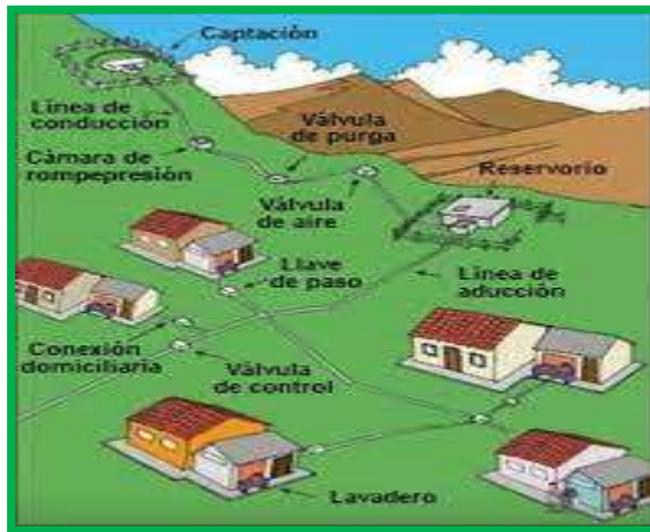
*figura 7.* Sistema de abastecimiento de agua potable
