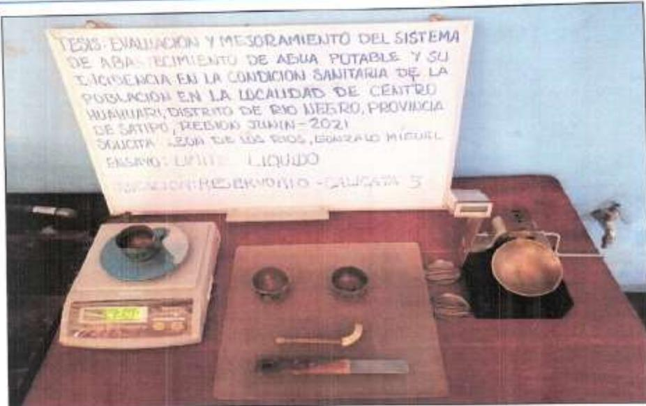
ENSAYO DE LIMITE LIQUIDO DE LA CALICATA 2 UBICADO EN EL
