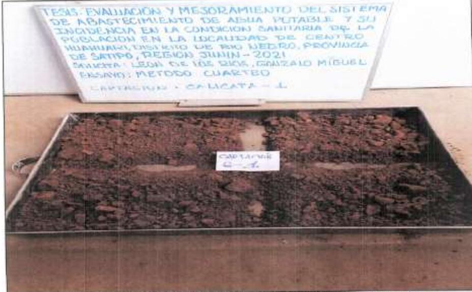
ENSAYO DE METODO DE CUARTEO DE LA CALICATA 1 UBICADO EN EL
