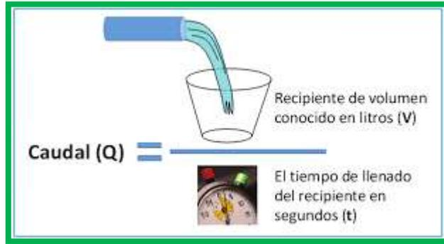
**Figura 5.** Medida del caudal por el método volumétrico
