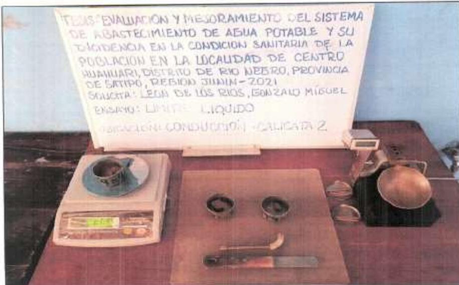
ENSAYO DE LIMITE LIQUIDO DE LA CALICATA 3 UBICADO EN EL KM:0+885 DE LA LINEA DE ADUCCION
