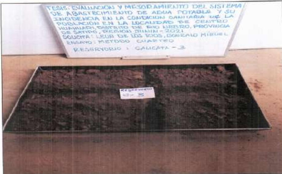
ENSAYO DE METODO DE CUARTEO DE LA CALICATA 2 UBICADO EN EL KM: 0+470 DEL RESERVORIO
