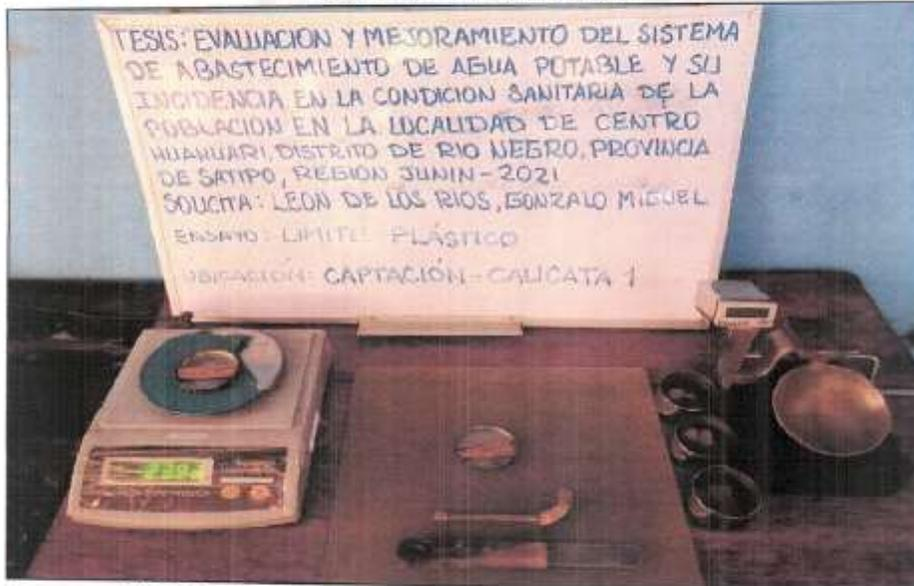
ENSAYO DE LIMITE PLASTICO DE LA CALICATA 1 UBICADO EN EL KM: 0+00 DE LA CAPTACION
