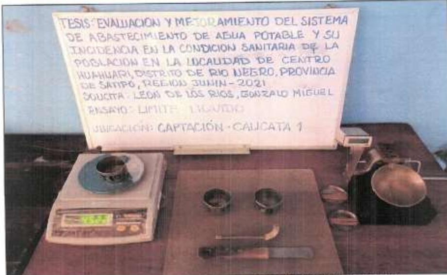
ENSAYO DE LIMITE LIQUIDO DE LA CALICATA 1 UBICADO EN EL KM: 0+00 DE LA CAPTACION
