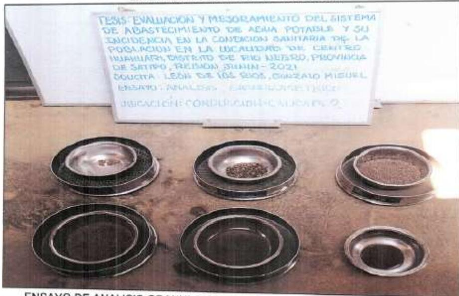
ENSAYO DE ANALISIS GRANULOMETRICO DE LA CALICATA 3 UBICADO EN EL KM:0+885 DE LA LINEA DE ADUCCION
