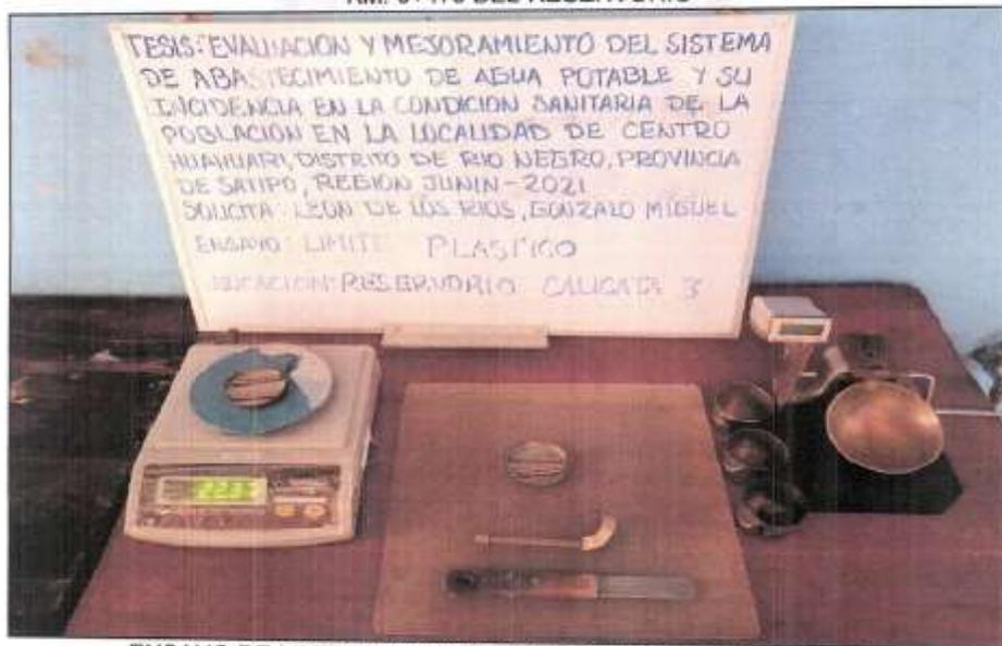
ENSAYO DE LIMITE PLASTICO DE LA CALICATA 2 UBICADO EN EL
