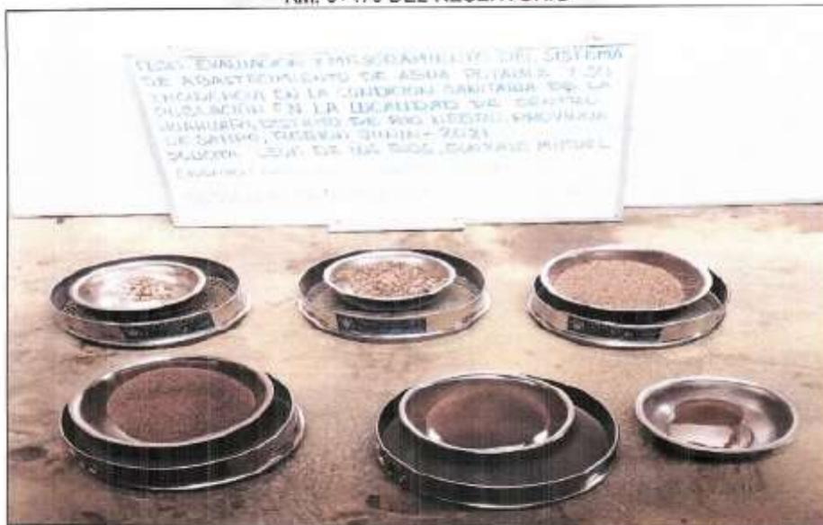
ENSAYO DE ANALISIS GRANULOMETRICO DE LA CALICATA 2 UBICADO EN EL KM: 0+470 DEL RESERVORIO
