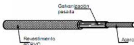
Generalmente se exige que el recubrimiento en PVC tenga un espesor nominal de 0.55 mm y mínimo de 0.38 mm.
