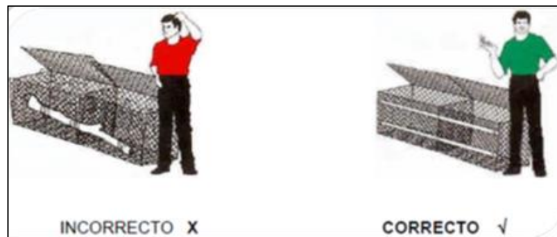
Figura 12: Conformar los gaviones
