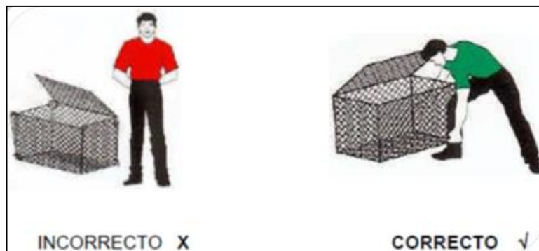
Figura 8: Armado de los gaviones
