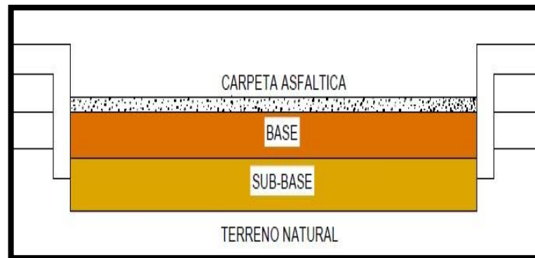
Gráfico N°01: Estructura típica de un pavimento asfáltico (flexible).
