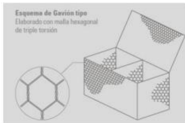
Figura 3: Muro de gavión tipo caja
