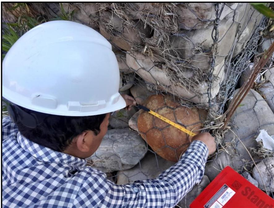
**Figura 43:** Medición de las dimensiones de las rocas (relleno)
