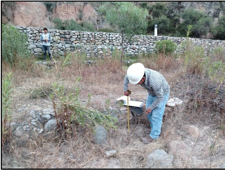
**Figura 64:** Medición del espesor del colchón antisocavante
