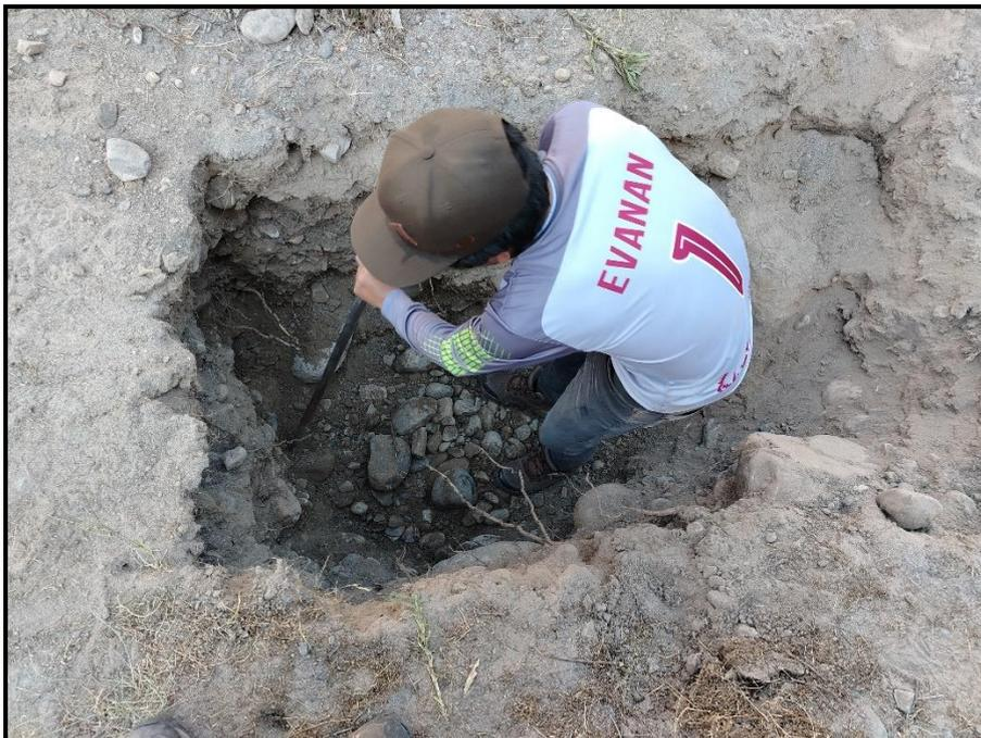
**Figura 69:** Excavación de calicata de 1.0mx1.50 m
