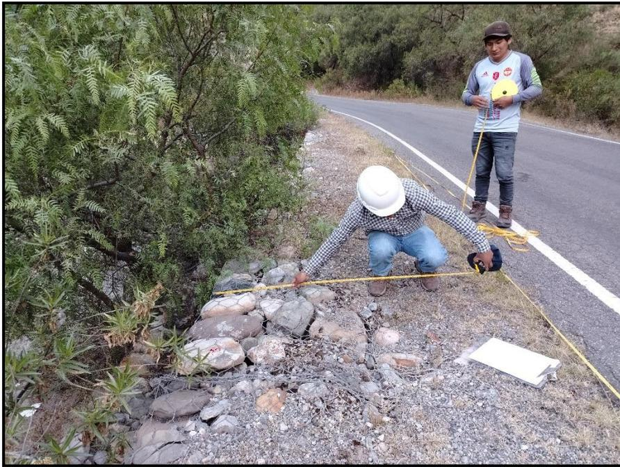
**Figura 50:** Medición del ancho de la corona del muro N°02
