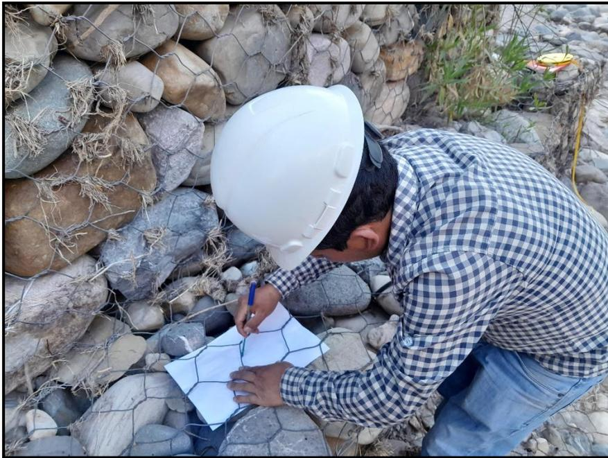
**Figura 44:** Determinación de la escuadría de las mallas hexagonales
