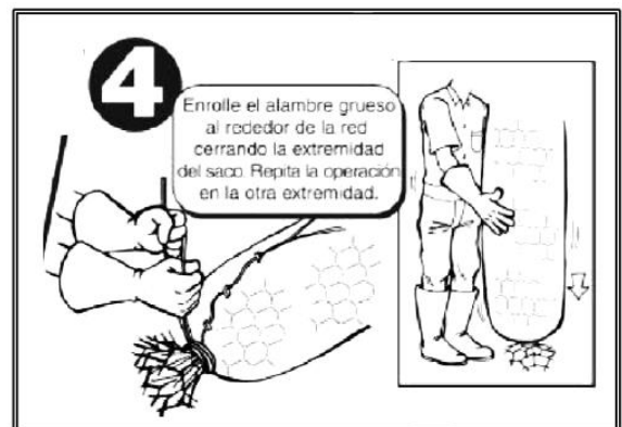
Figura 17. Conformado de las extremidades del gavión. Fuente: (Morassutti F, 2013)
