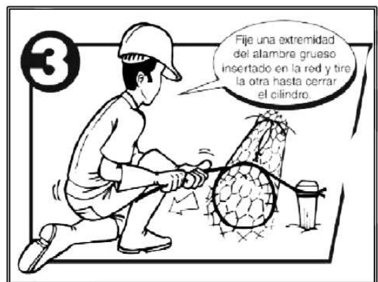
Figura 16. Amarre de los extremos. Fuente: (Morassutti F, 2013)
