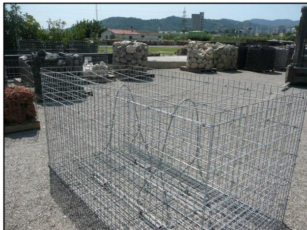
**Figura 5:** Mallas de gaviones galvanizados para una mejor duración y efectividad. Fue extraído del libro de Amórtegui et al (15).
