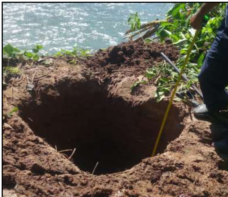
Imagen N°04. Material de muestra extraído para su análisis en laboratorio de mecánica de suelos.
