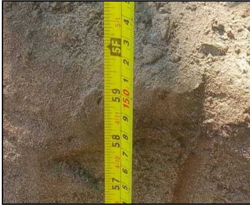
Imagen N°05. Profundidad de excavación para la calicata.
