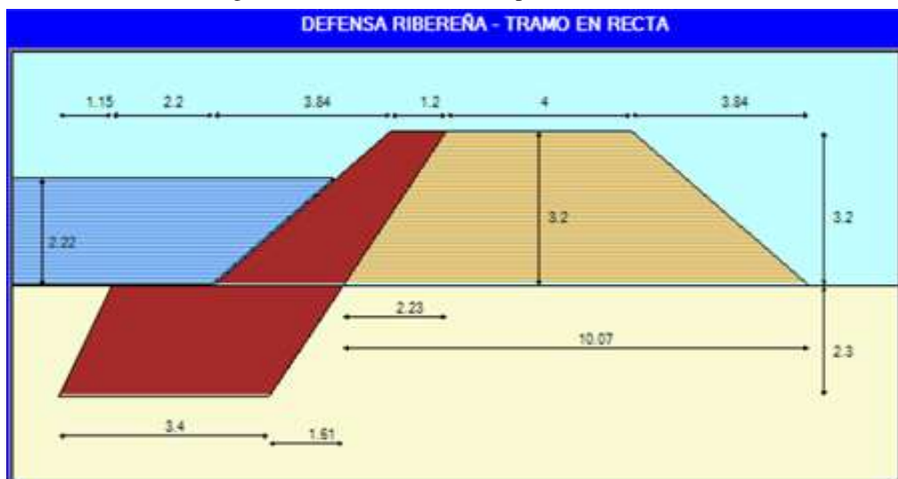
Figura 18: Dimensionamiento óptimas de enrocado.
