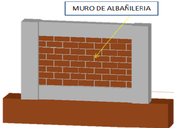
Imagen 8: Muros elementos de albañilería confinada.
