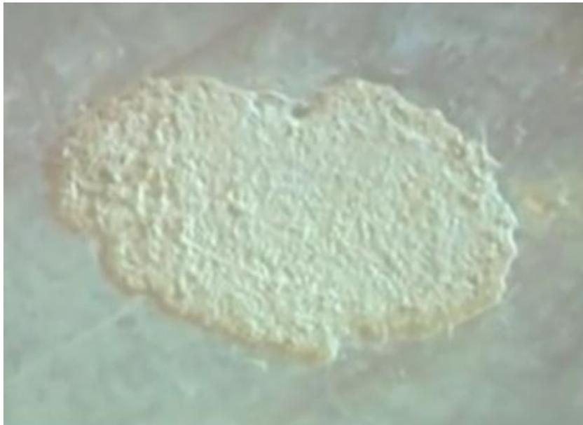
**Laminación del concreto por efecto del sangrado a lo largo de la superficie**
