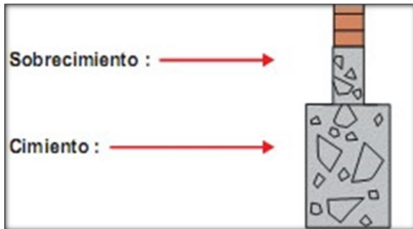
imágenes 4: Cimiento y sobrecimiento.
