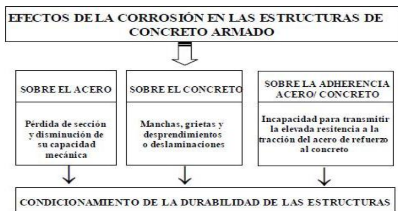
Figura N°20: Efectos de la corrosión en Concreto
