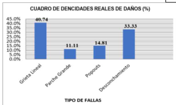
Figura 32. Gráfico de patologías y densidades registras en el pavimento rígido UM-01 Descripción.
