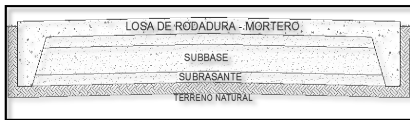
Figura 2. Esquema de las capas que integran un pavimento rígido.
