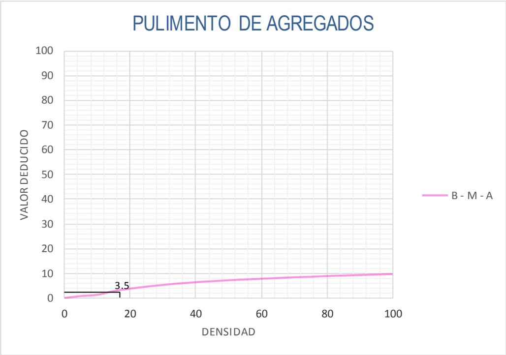
**Figura 78. Patología el Pulimento de Agregados UM – 03**
