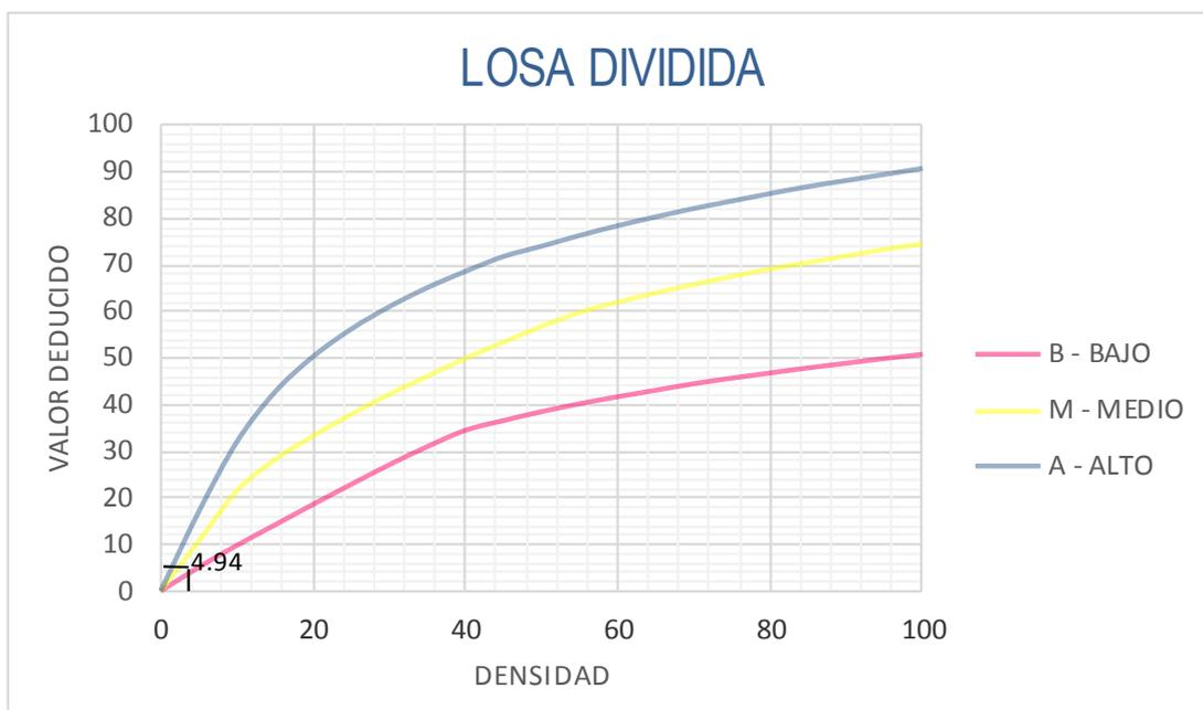
**Figura 66. Patología de Losa Dividida UM - 02**
