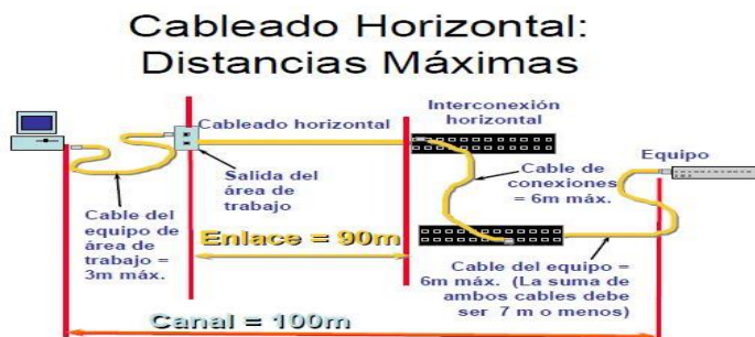
Gráfico Nro. 6: Elemento de un Cableado Horizontal
