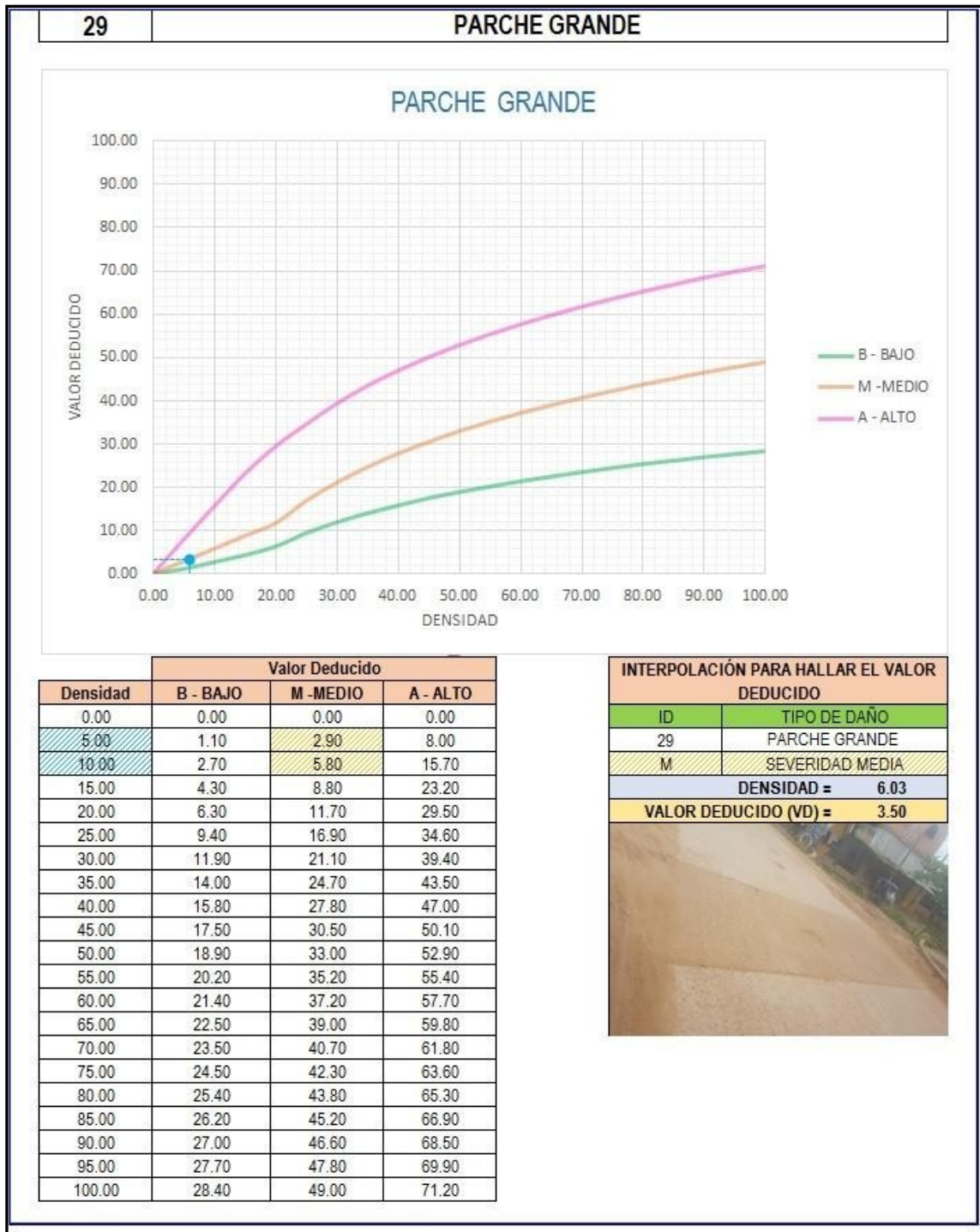
Figura 44: Grafico de las Grietas en parche grande UM-02
