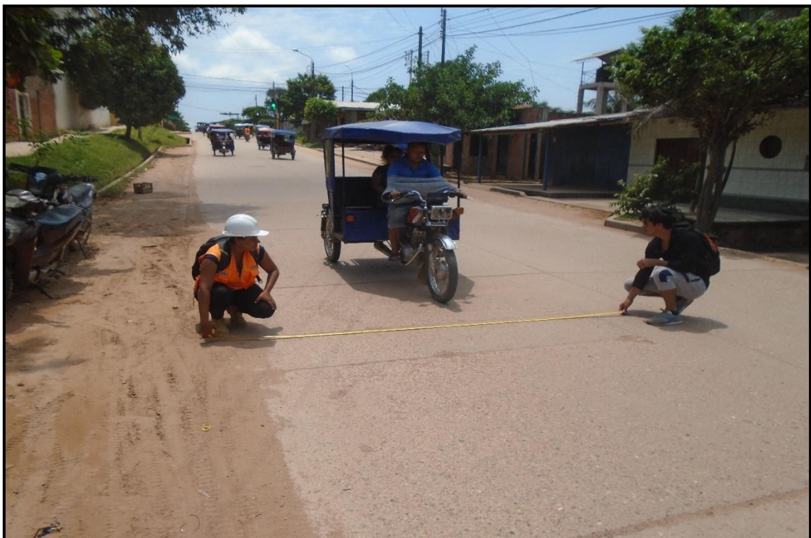
Figura 96: Daño Pulimento de Agregados y Parche Grande
