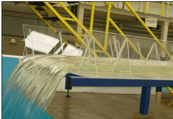
Figura 7: Canal de modelo construido en el laboratorio.
