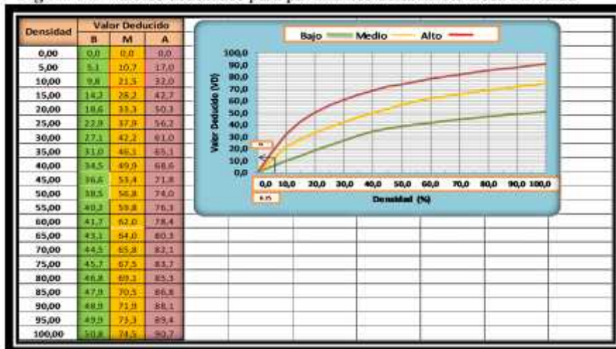
Figura 30. Valores deducidos para pavimentos de concreto Losa Dividida
