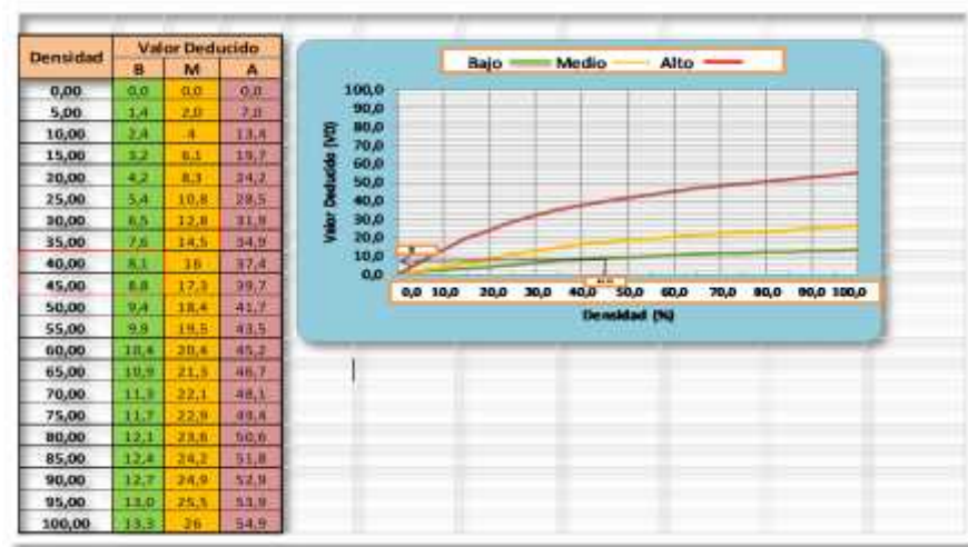
Figura 41. Valores deducidos para pavimentos de concreto descascaramiento de junta.
