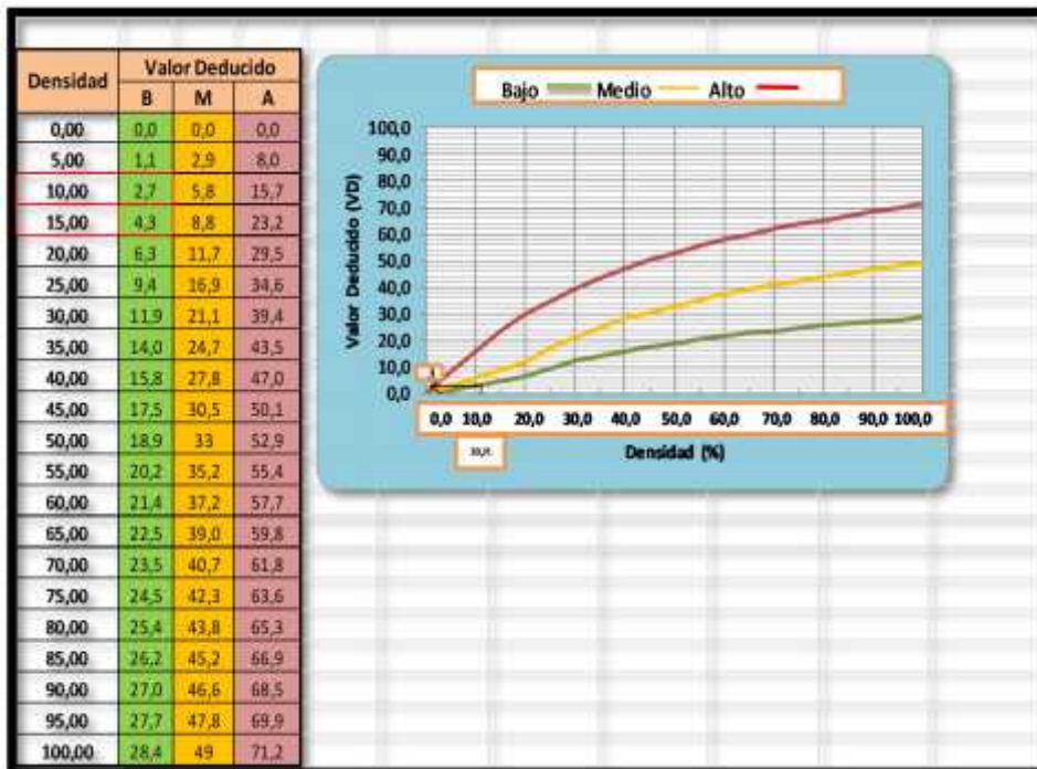
Figura 48. Valores deducidos para pavimentos de concreto Grietas Lineales
