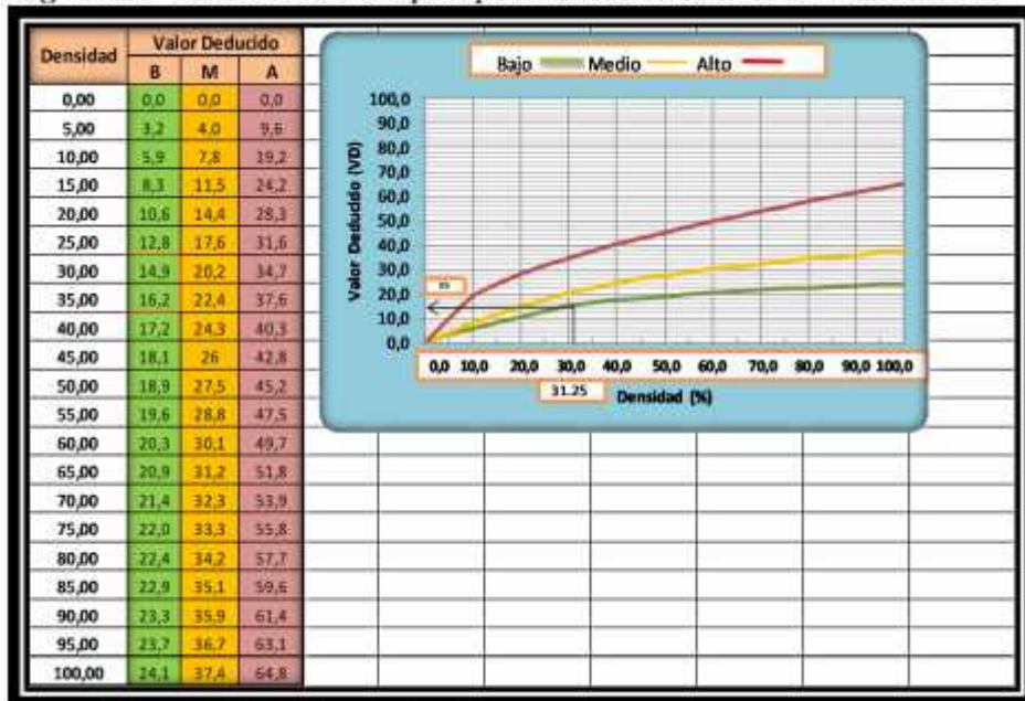
Figura 31. Valores deducidos para pavimentos de concreto Grietas Lineales
