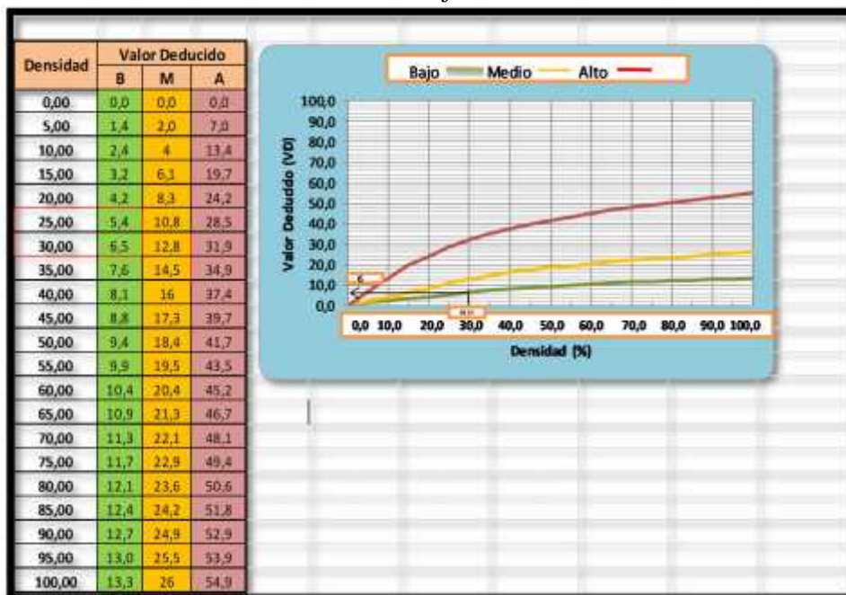
Figura 50. Valores deducidos para pavimentos de concreto descascaramiento de junta
