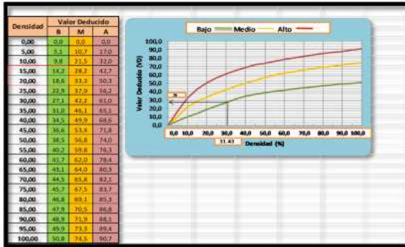
Figura 45. Valores deducidos para pavimentos de concreto Losa Dividida
