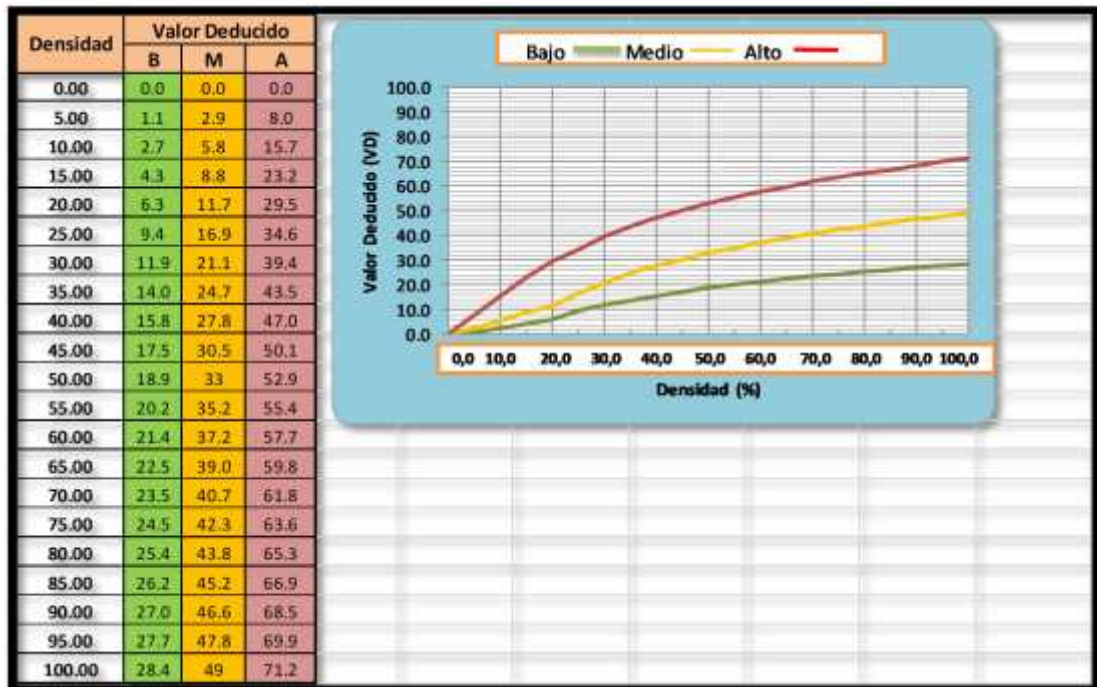
Figura 79. Valores deducidos para pavimentos de concreto parche grande. (Mayor de 0.45 m 2 ) y acometidas de servicio Público.
