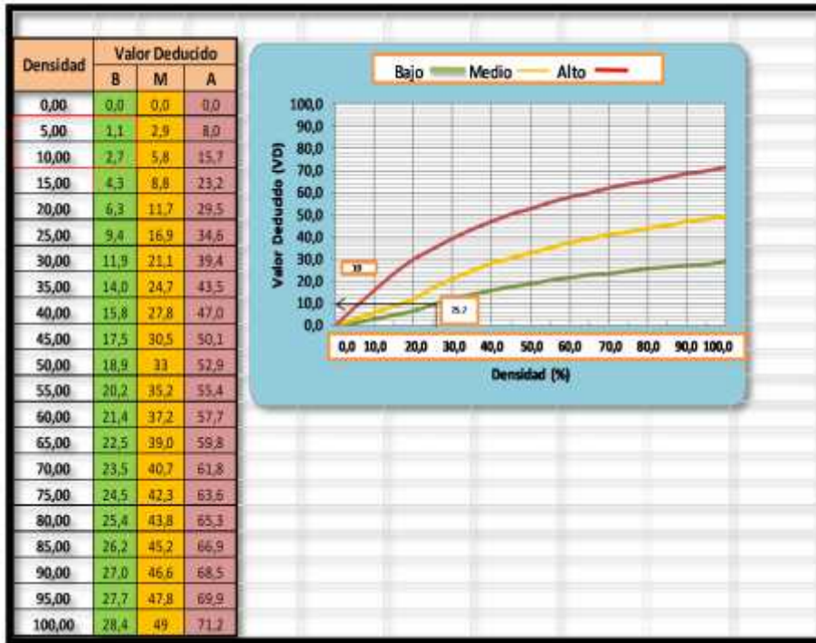
Figura 47. Valores deducidos para pavimentos de concreto parcheo grande (> 0,5 M2)
