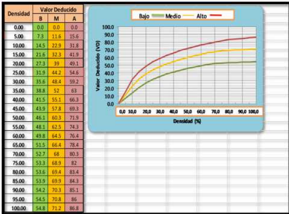
Figura 81. Valores deducidos para pavimentos de concreto punzonamiento.
