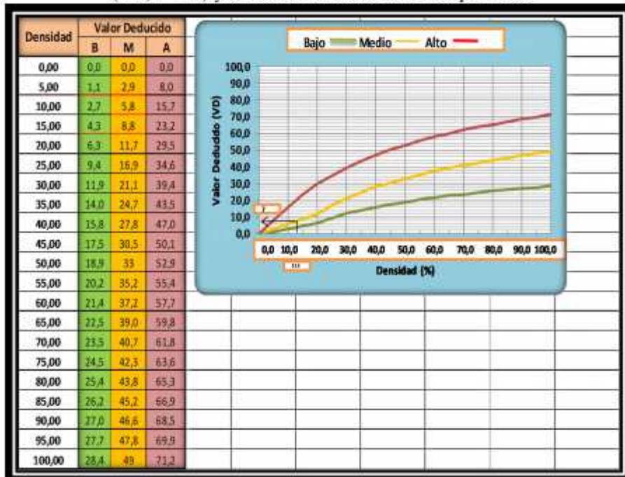
Figura 33. Valores deducidos para pavimentos de concreto parcheo grande (> 0,5 m 2 ) y otra acometida de servicios públicos.
