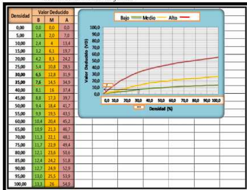
Figura 34. Valores deducidos para pavimentos de concreto descascamiento de junta.
