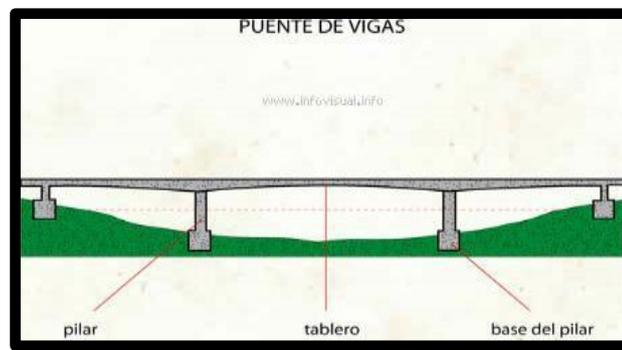
**Figura 20. Puentes Tipo Vigas**
