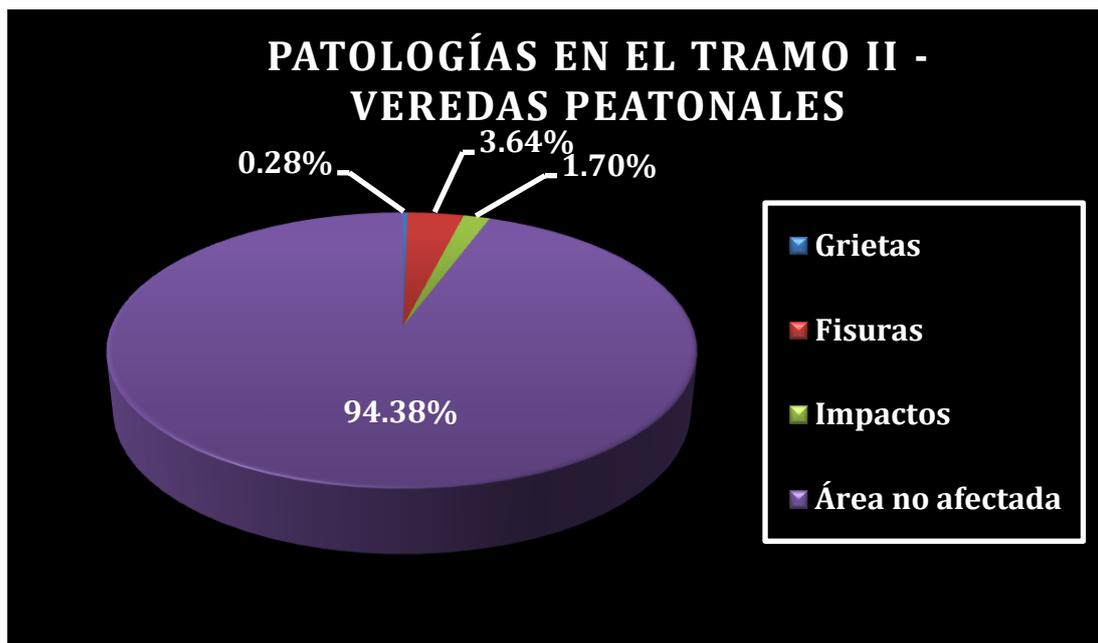
**Figura 140. Tipos de Patologías existentes en Veredas Peatonales (Tramo II)**
