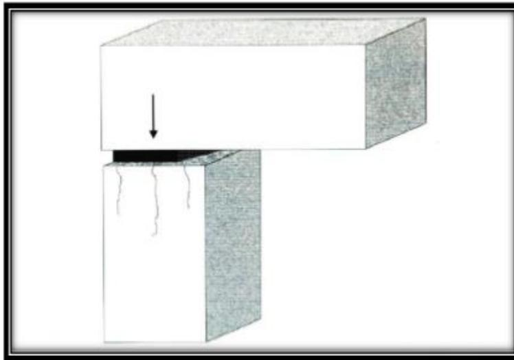
**Figura 100 Falla local por aplastamiento debida a una carga Concentrada en una columna.**
