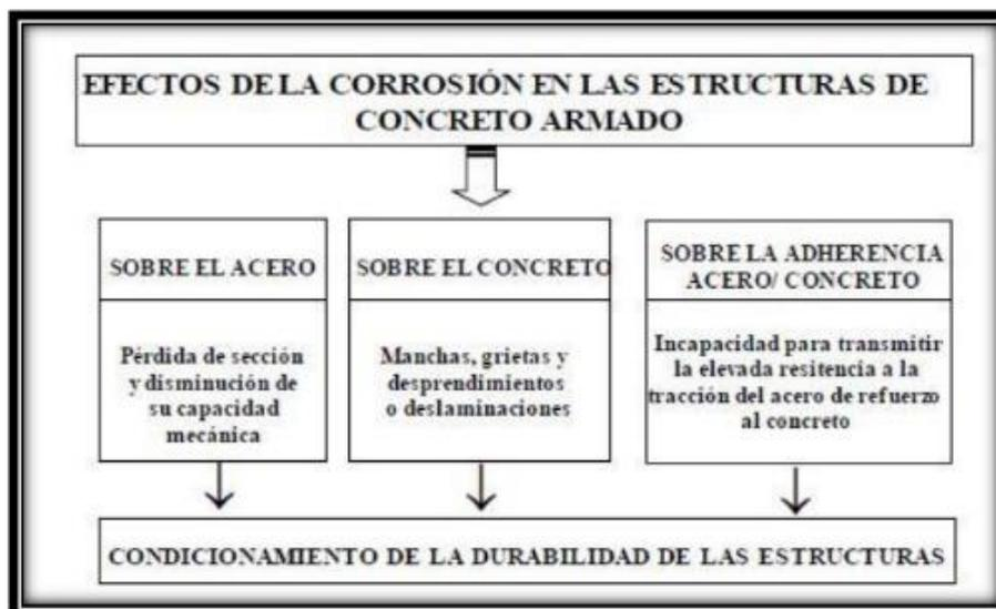
**Figura 110. Efectos de la corrosión**
