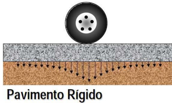
*Figura 1. Pavimento rígido*
