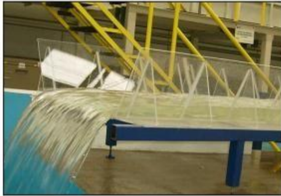
Figura 7: Canal de modelo construido en el laboratorio.
