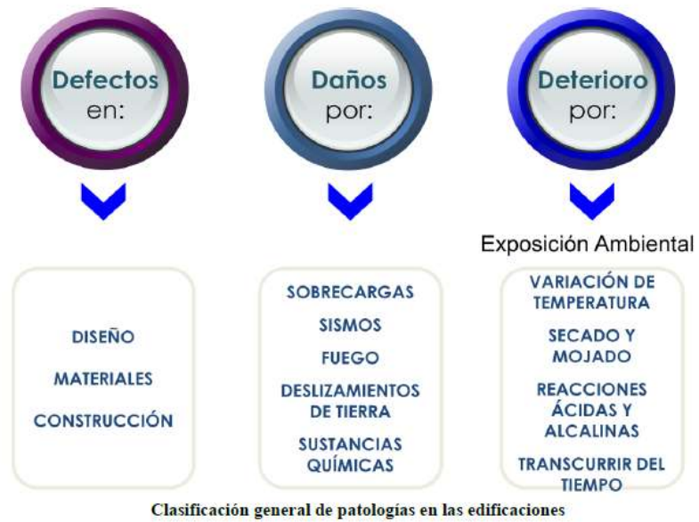
Gráfico 01: Clasificación general de patologías en las edificaciones.
