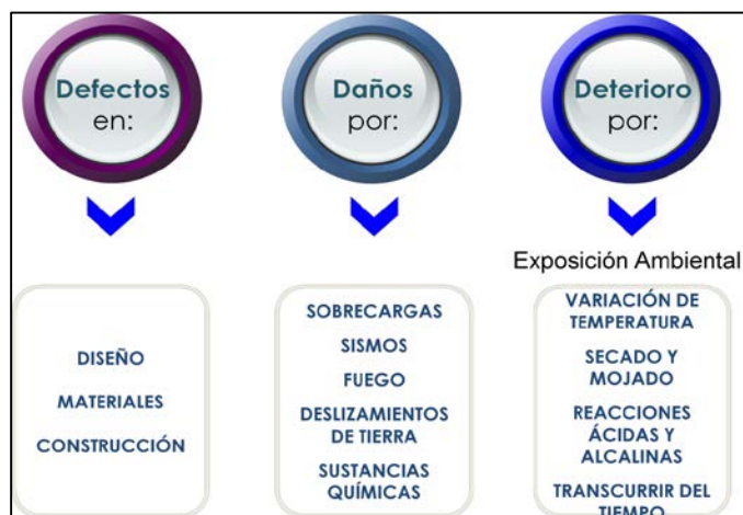
Figura 8. Clasificación general de patologías en las edificaciones.
