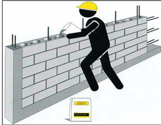
Figura 6. Llenado del grout en el muro armado. Nota. Fuente: Melchor L. (2016).
