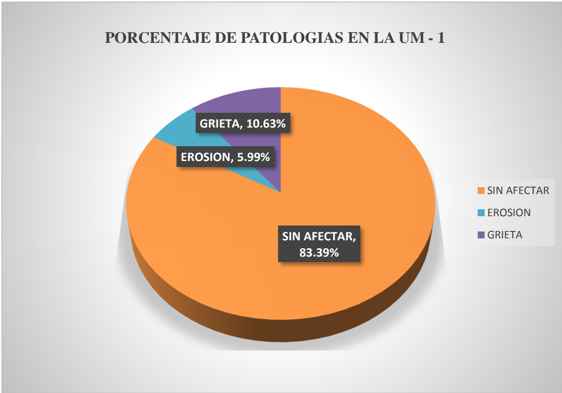
Gráfico 12: Porcentaje de patologías en la unidad de muestra 3 Nota. Fuente propia (2018)
