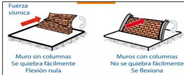
Imagen 13. Función de las Columnas
