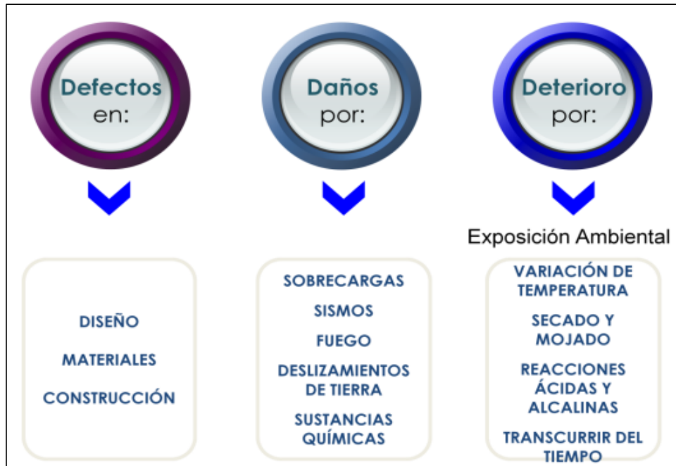
Figura 12. Clasificación general de patologías en las edificaciones Fuente: Astorga, A. y Rivero, P. (2009). Patologías en las edificaciones. Módulo III – Sección IV. (p. 3)
