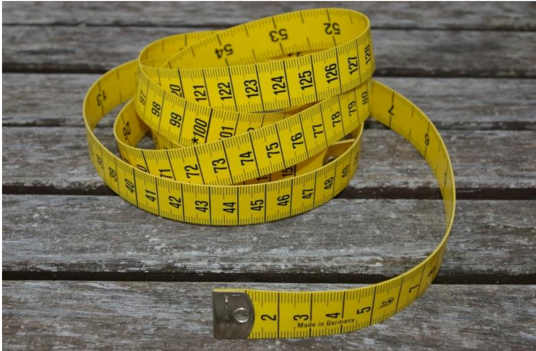
Figura 152. Cinta métrica para establecer las profundidades de las depresiones o ahuellamientos.
