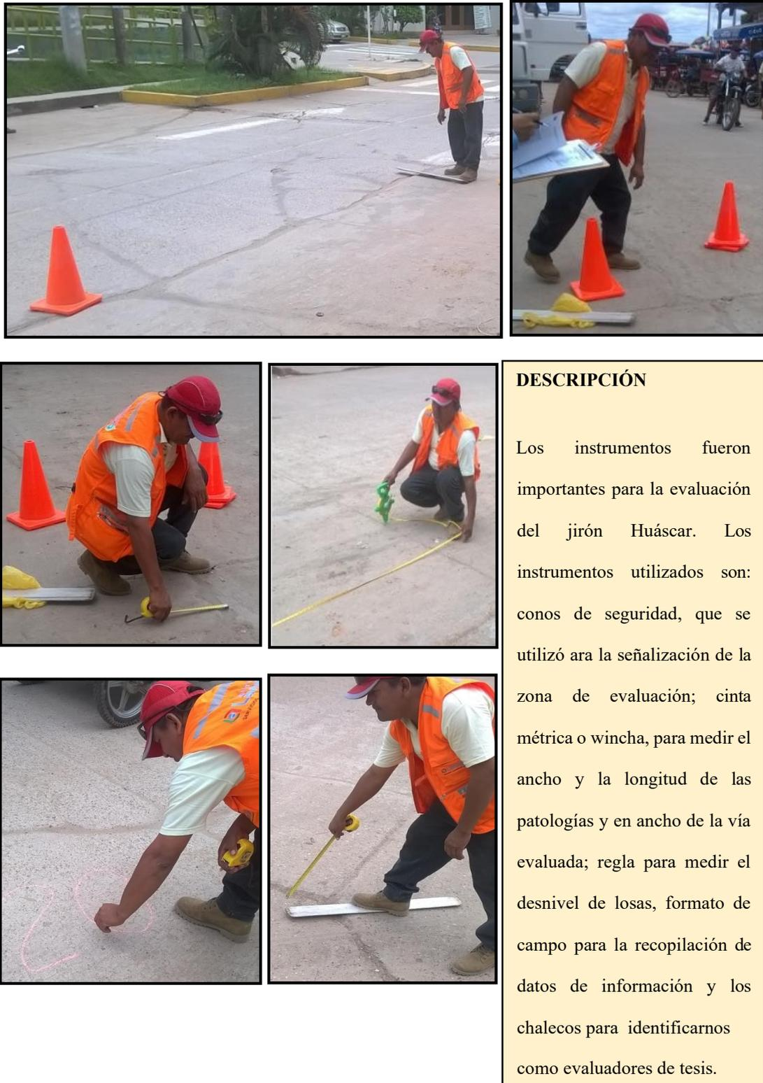
*Figura 126:* Instrumentos utilizados en la investigación.
