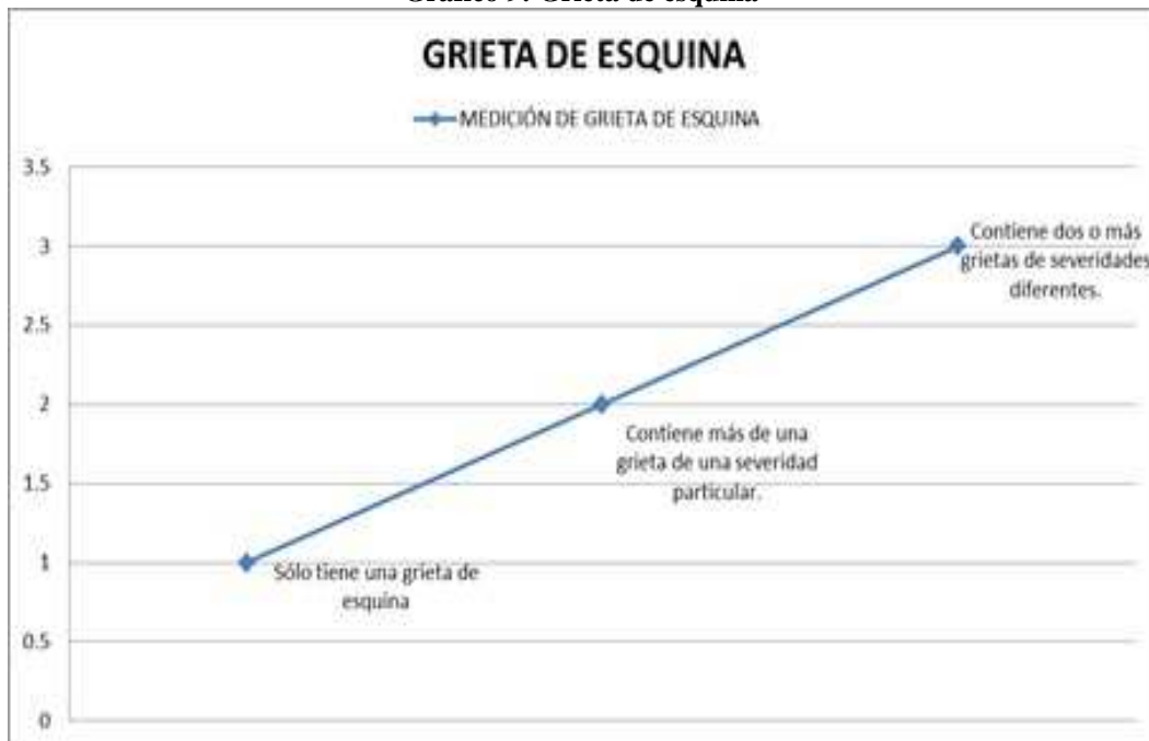
Gráfico 9: Grieta de esquina
