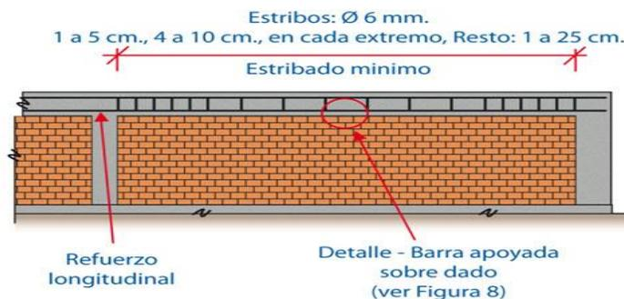
Figura 3. Albañilería Armada
