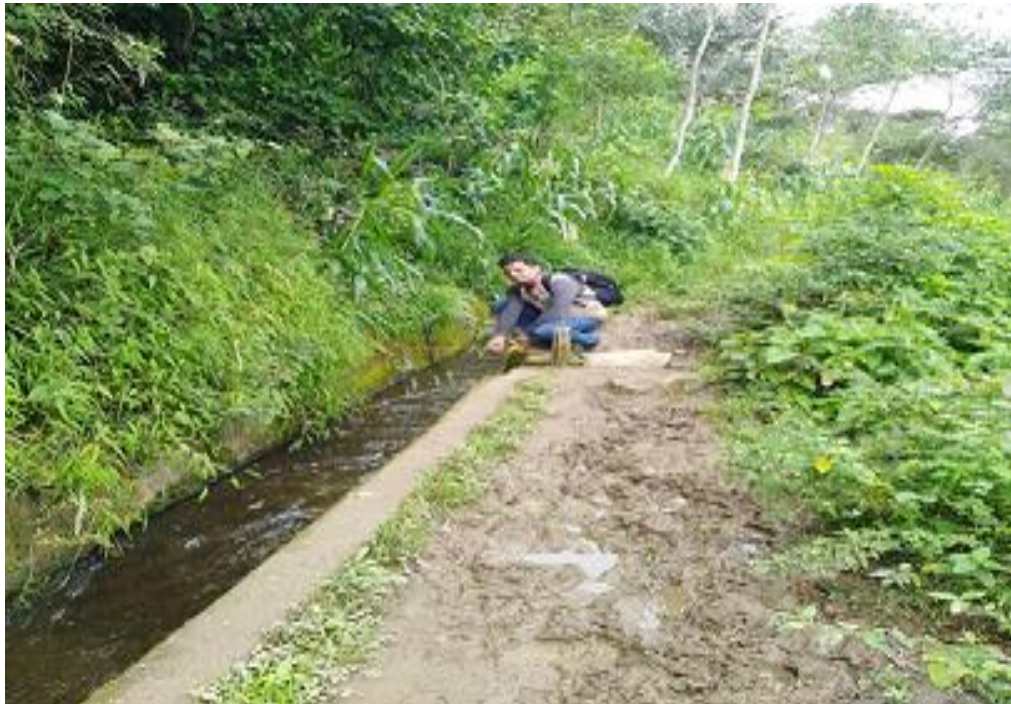
Fotografía 05: Se muestra realizando las medidas de la sección Hidráulica del canal de regadío Santa Ana. Fuente: Elaboración Propia.
