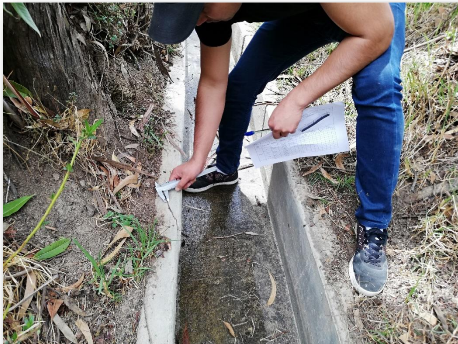
Grieta de 5.2 mm. originada por el crecimiento de la raíz de un árbol.
