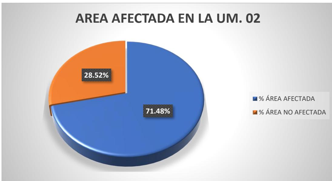
**Interpretación:** Se observa que el 71.48% del área total de la unidad muestral 02 está dañada con las patologías como Grieta, Erosion, Fracturamiento, Moho y Desgaste siendo Fracturamiento con mayor daño estructural, y el 28.52% no presenta patologías.
