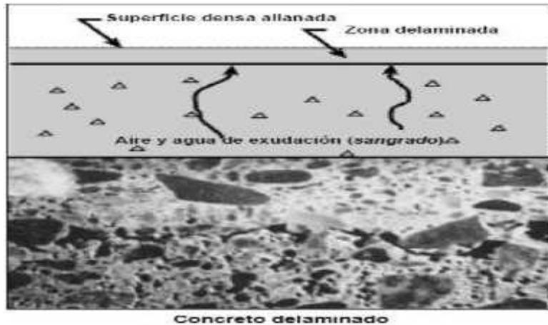
**Gráfico N° 09: Delaminación de las superficies de concreto terminada con llana**
