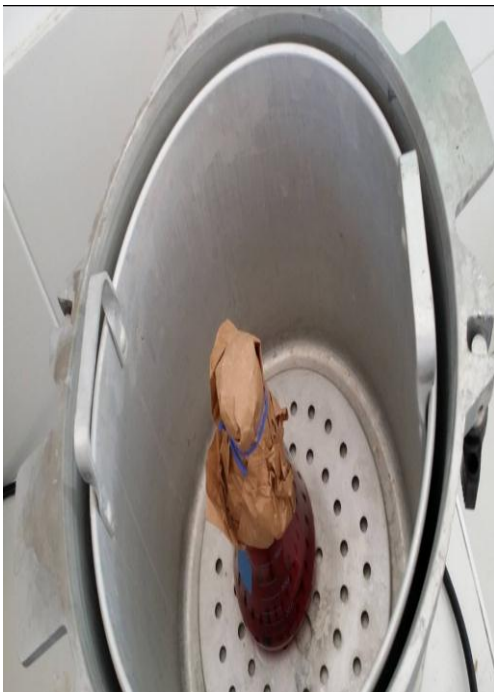
Figura N° 10: Exposición del agar Mac Conkey en el autoclave.
