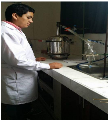
Figura N° 3: Extracción del aceite esencial de albahaca.
