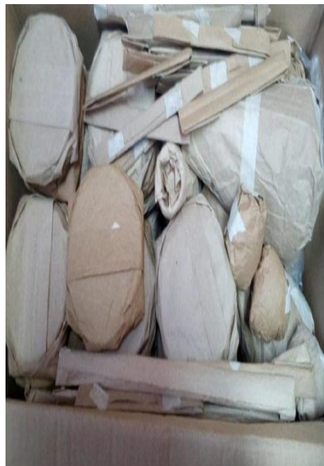
Figura N° 7: Material esterilizado: placas Petri, matraz, varillas, etc.
