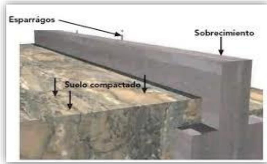
Figura 12: Detalle de sobre cimientado - Fuente: Blogspot Guarda construcciones.
