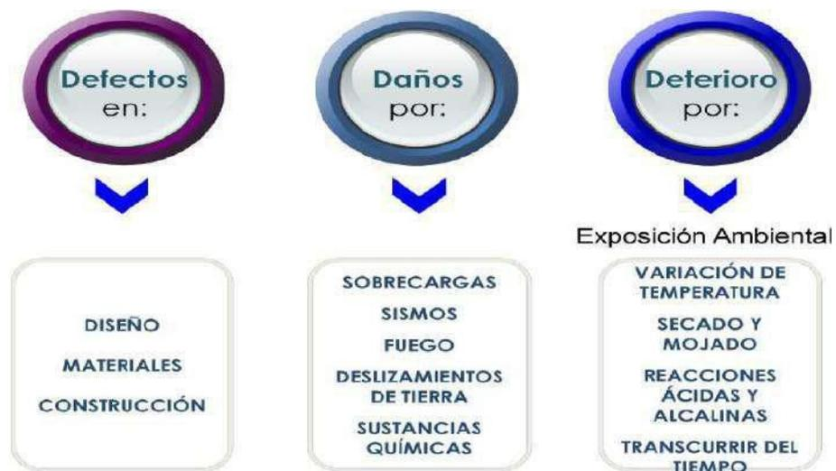
Figura 19. "Clasificación general de patologías en las edificaciones Nota. Fuente: Astorga, A. y Rivero, P. (2009). Patologías en las edificaciones. Módulo III - Sección IV". (p. 3)
