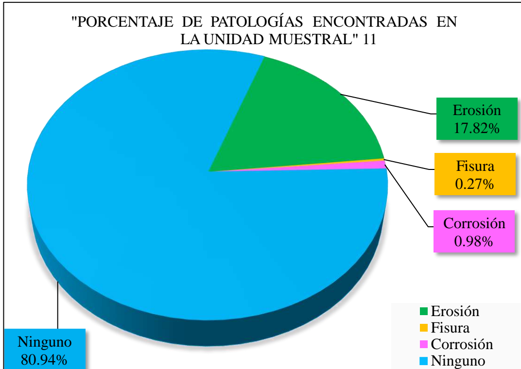
Figura 75. Porcentaje de patologías encontradas en la Unidad Muestral 11. Nota. Fuente: Elaboración propia. (2018).
